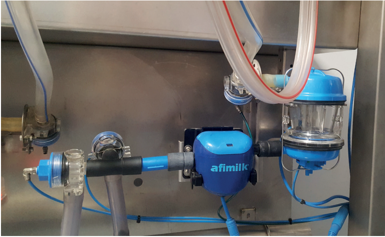
სურათი #31 - მასტიტზე ინდივიდუალური ტესტირების მოწყობილობა
