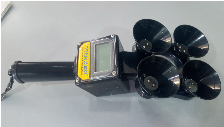
სურათი #32 - მასტიტზე შემონმების პორტატული ელექტროხელსაწყო
